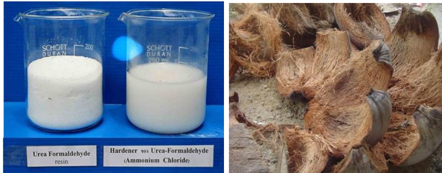
ภาพที่ 2 กาวเรซินยูเรียฟอร์มัลดีไฮด์ และกาบเปลือกมะพร้าว ที่มา : พิชิต พจนพาที
