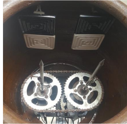
ภาพที่ 1 ลักษณะภายนอกและภายในของเตาอบโองสำหรับการผลิตโอบโองโดยใช้ความร้อนจากรังสีอินฟราเรดไกล
