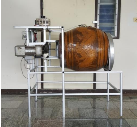
ภาพที่ 1 ลักษณะภายนอกและภายในของเตาอบโองสำหรับการผลิตโอบโองโดยใช้ความร้อนจากรังสีอินฟราเรดไกล
