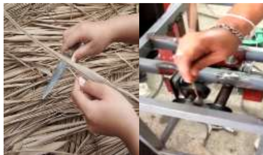
ภาพที่ 6 การทดลองการเหลาก้านมะพร้าวโดยใช้คนและเครื่องเหลาก้านมะพร้าว
