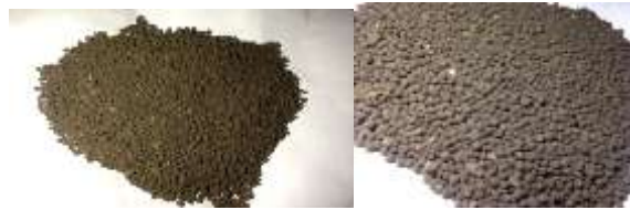
ภาพที่ 8 ผลผลิตที่ได้จากเครื่องปั้นเม็ดปุ๋ยโดยใช้พลังงานก๊าซชีวภาพ (ขนาดเม็ด 3-6 มม.)
