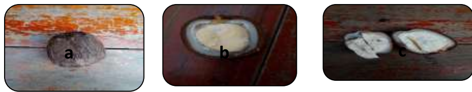
ภาพที่ 7. (a) เมล็ดตาลโดนด,(b) เมล็ดตาลโดนดที่ผ่าด้วยเครื่องจักร,(c) เมล็ดตาลโดนดที่เกิดความเสียหายจากการผ่าด้วยเครื่อง
