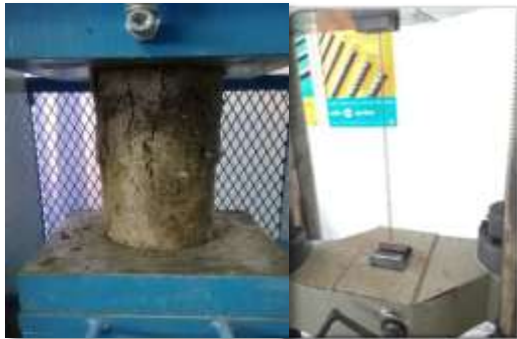
ภาพที่ 2 แสดงการทดสอบกำลังอัดคอนกรีตและการทดสอบแรงดึงเหล็ก
