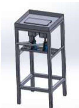
ภาพที่ 1 แสดงแบบ 3D เครื่องอัดกระดาษจากขี้เลื่อย
