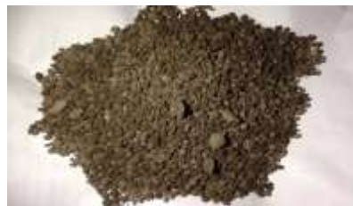
ภาพที่ 7 ผลผลิตที่ได้จากเครื่องปั่นเม็ดปุ๋ยโดยใช้พลังงานก๊าซชีวภาพ (ยังไม่คัดขนาดเม็ดปุ๋ย)
