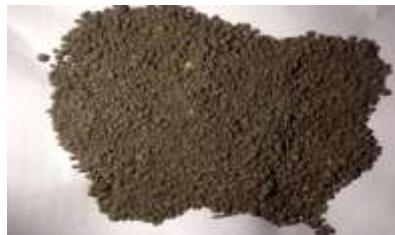
ภาพที่ 9 ผลผลิตที่ได้จากเครื่องปั้นเม็ดปุ๋ยโดยใช้พลังงานก๊าซชีวภาพ (ขนาดเม็ดเล็กกว่า 3 มม.)
