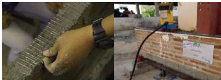
ภาพที่ 5 การเสริมลวดตาข่ายตามแนวปูนก่อและแสดงการเตรียมทดสอบผนังตัวอย่าง
