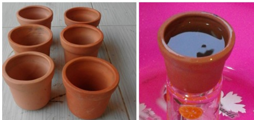
ภาพที่ 3 การนำชิ้นงานที่เผาในอุณหภูมิ 1000 องศาเซนเซียสไปทดสอบการซึมของน้ำ ที่มา : พิชิต พจนพาที, 2560
