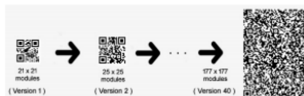
ภาพที่ 2 การเพิ่มจำนวนโมดูลในแต่ละเวอร์ชันของ QR Code อ้างอิงจากงานวิจัยเรื่อง ความหลากหลายของคิวอาร์โค้ด ญัฐฉัตร บุญโรจน์วงศ์ และกชกร พระพรตระการ
