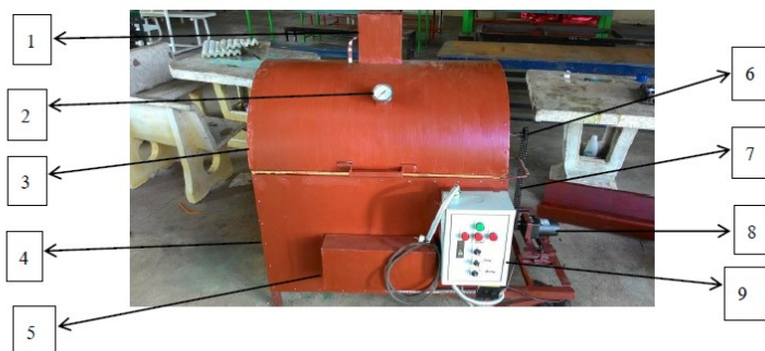
ภาพที่ 3 ส่วนประกอบเครื่องอบแห้งเมล็ดแมคคาเดเมียแบบถังหมุน
