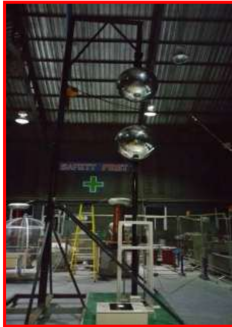
รูปที่ 1 โครงสร้างชุดจับยึดลูก Sphere Gaps
