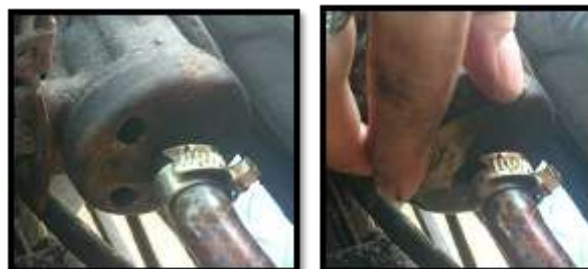
รูปที่ 4 วิธีการแต่งปริมาณก๊าซที่เข้าไปในเครื่องยนต์
