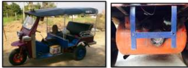
รูปที่ 10 รถตุ๊กตุ๊ก เครื่องยนต์ไดฮัทส 356 ซีซีและถังก๊าซปิโตรเลียมเหลวขนาด 25 ลิตร
