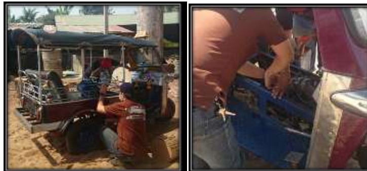
รูปที่ 3 ปรับแต่งรถตุ๊กตุ๊กให้ใช้ได้กับก๊าซชีวภาพ
