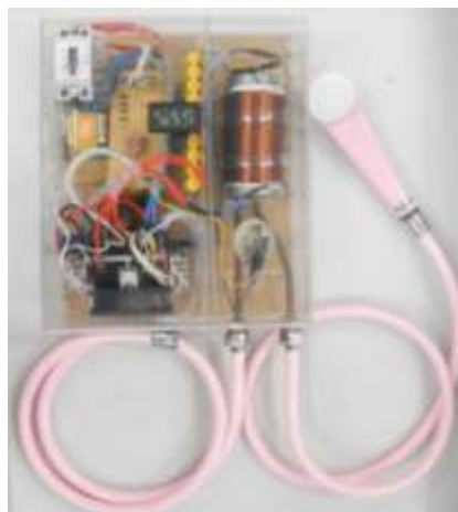
ภาพที่ 6 แสดงเครื่องทำน้ำอุ่นโดยใช้หลักการเหนี่ยวนำ
