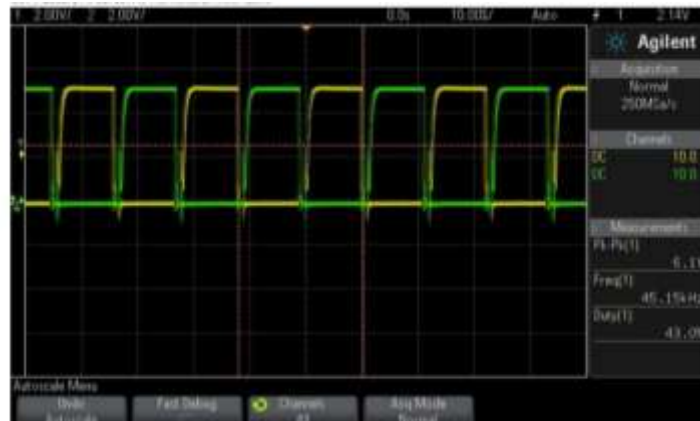
ภาพที่ 7 แสดงรูปสัญญาณพัลส์ที่ออกจากไอซี SG3525 ที่ความถี่ 45 กิโลเฮิร์ตซ์
