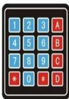
รูปที่ 4 คีย์แพดสวิทช์ที่ใช้ในเครื่องนับเม็ดยา รุ่นที่ 2
