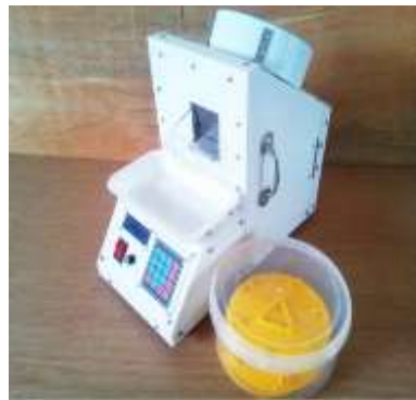
รูปที่ 2 เครื่องนับเม็ดยารุ่นที่ 2 ที่สร้างเสร็จสมบูรณ์
