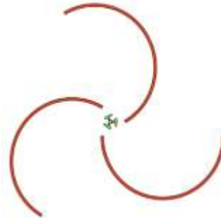
รูปที่ 5 ลักษณะใบพัดของกังหันเอส-แพดเดิล
